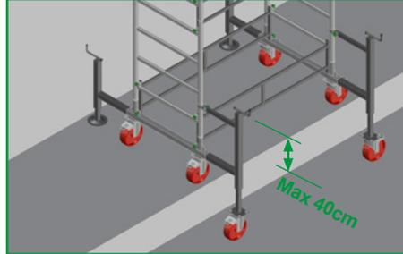
I livellatori con ruote sono accessori che **permettono lo spostamento agevole del trabattello su superfici con un dislivello fino a 40cm** (es. Marciapiedi). I livellatori con ruote possono essere utilizzati su Gemini e GeminiPro fino ad un'altezza al piano di 8m.
